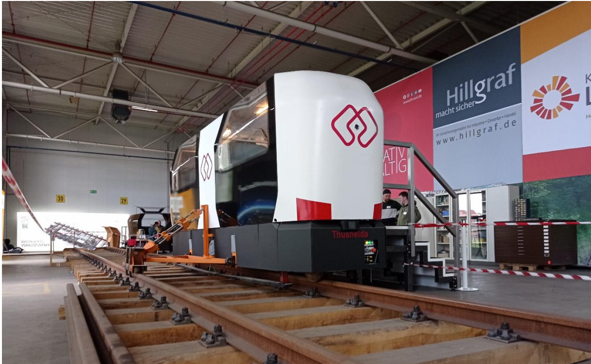
Abbildung 4: 20m-Teststrecke in der Montagehalle BEGA-Park Dörentrup mit Auffangvorrichtung (Brunsing / TU Dortmund)
